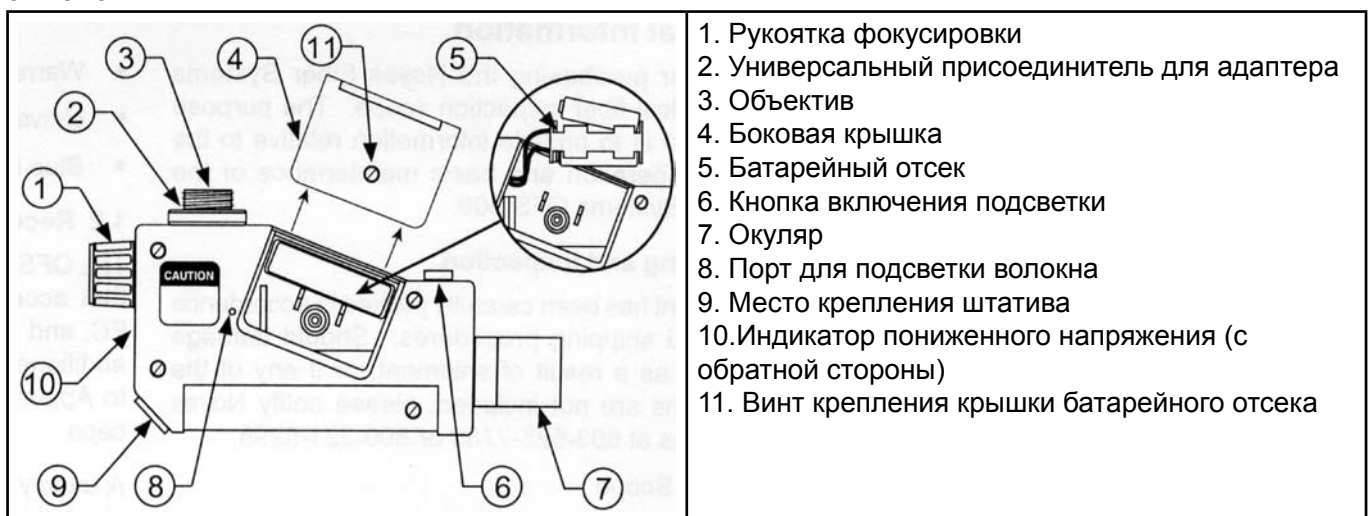
Рис.1. Составные части микроскопа
